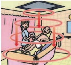
機械式浴槽の広い浴室に遠赤外線放射熱と温風対流によるダブルパワーで、浴槽の周辺のみを効率よく暖めます。
