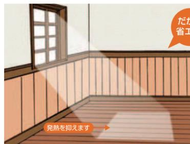
窓からの日射しにより、一定範囲の床面温度が上昇するとプラヒートのPTC特性により、その部分の発熱を抑え、周辺の床面温度と均等に保つ働きをします。
